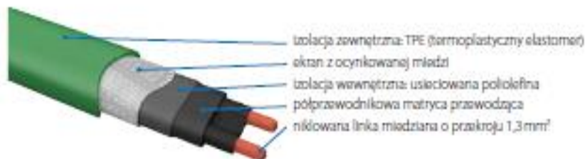
Budowa kabla grzejnego samoograniczającego
