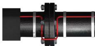
Sposób montażu kabla grzejnego na złączu kołnierzowym
