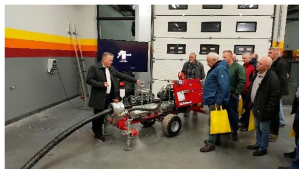
Urządzenie nowoczesnej technologii wdmuchiwa- nia kabli elektroenergetycznych WATUCAB. (zdjęcie kol. Dariusz Stecki)
